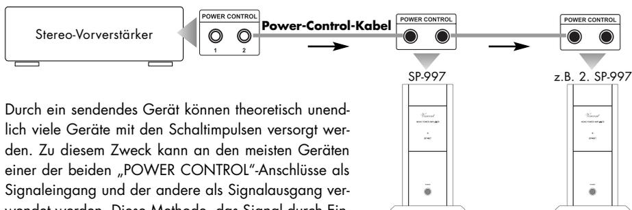
Durch ein sendendes Gerät können theoretisch unendlich viele Geräte mit den Schaltimpulsen versorgt werden. Zu diesem Zweck kann an den meisten Geräten einer der beiden „POWER CONTROL“-Anschlüsse als Signaleingang und der andere als Signalausgang verwendet werden. Diese Methode, das Signal durch Ein- und Ausgänge der Geräte durchzuschleifen und diese somit zu verketteten, wird auch als „daisy chaining“ bezeichnet.
