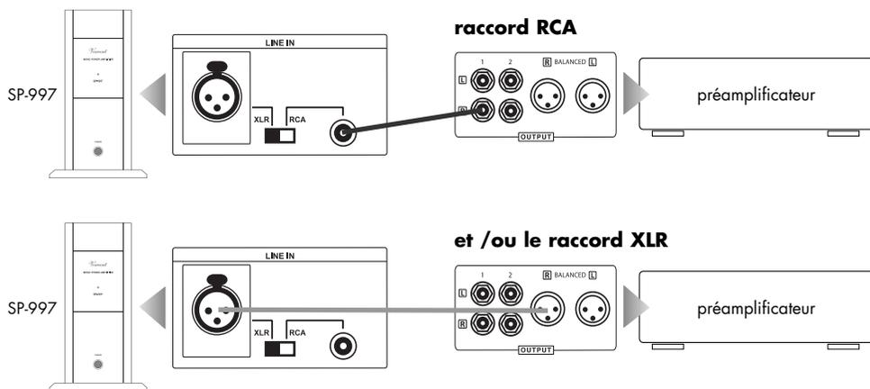
Les deux raccords « LINE IN » doivent être garnis concomitamment, par ailleurs, il est possible de raccorder simultanément deux préamplificateurs et de changer, au besoin, le raccord d'entrée « LINE IN » de votre choix. Avant de le faire, assurez-vous que le volume de ces préamplificateurs n'est pas réglé à une valeur très élevée.
