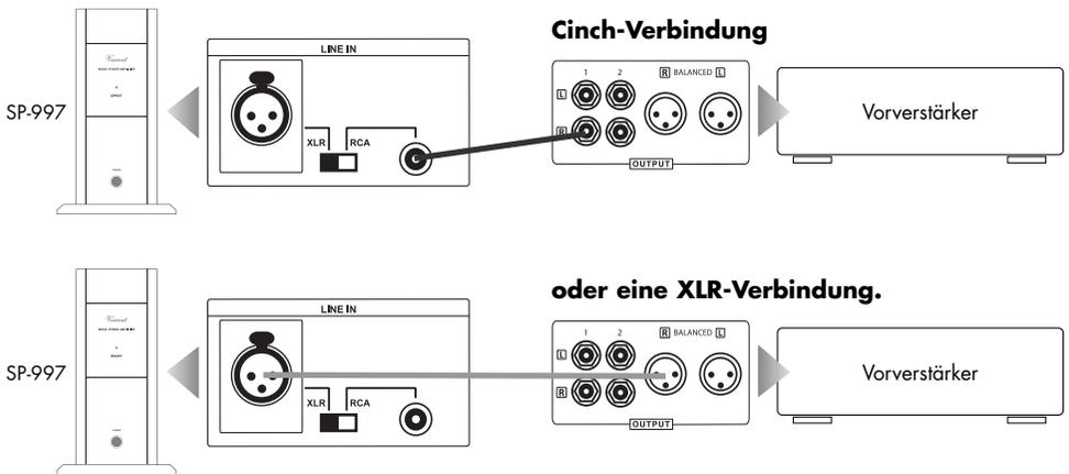
Beide „LINE IN“-Anschlüsse dürfen gleichzeitig belegt sein und es ist so möglich, zwei Vorverstärker gleichzeitig anzuschließen und nach Bedarf auf den gewünschten „LINE IN“-Eingangsanschluss umzuschalten. Bevor Sie dies tun, stellen Sie sicher, dass die Lautstärke des jeweiligen Vorverstärkers nicht zu hoch eingestellt ist.
