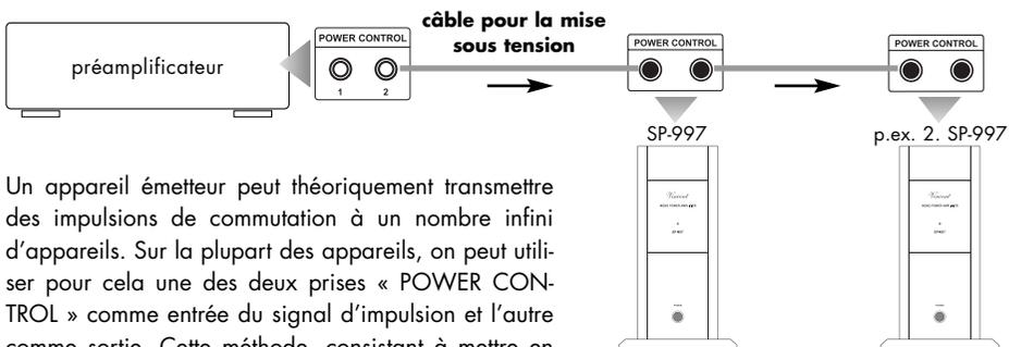
Un appareil émetteur peut théoriquement transmettre des impulsions de commutation à un nombre infini d'appareils. Sur la plupart des appareils, on peut utiliser pour cela une des deux prises « POWER CONTROL » comme entrée du signal d'impulsion et l'autre comme sortie. Cette méthode, consistant à mettre en circuit les entrées et les sorties des appareils et de les enchaîner ainsi, est aussi appelée « daisy chaining ».
