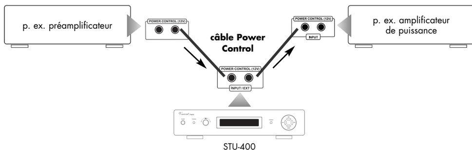
Grâce à un appareil transmetteur, un nombre illimité d'appareils peut être en théorie alimenté avec des impulsions de distribution. Pour ce faire, on pourra utiliser sur la plupart des appareils une des deux prises « POWER CONTROL » comme entrée du signal et l'autre comme sortie du signal. Cette méthode, consistant à mettre en circuit les entrées et les sorties des appareils et de les enchaîner ainsi, est aussi appelée « daisy chaining ».
