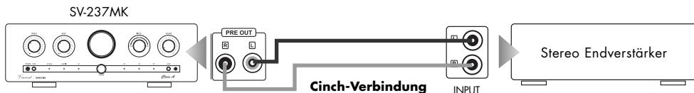
Anstelle des hier gezeigten Stereo-Endverstärkers können ebenso zwei Mono-Endverstärker eingesetzt werden.
