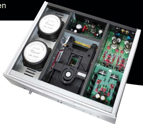
den analogen Teil des CD-S8 bereit, der andere versorgt die digitale Sektion. Somit ist sichergestellt, dass es zu keinen Beeinflussungen zwischen den digitalen und analogen Signalen kommt. Das Ergebnis ist eine hörbare Verbesserung der Musikinformation und Klangreinheit sowie der Dynamik.
